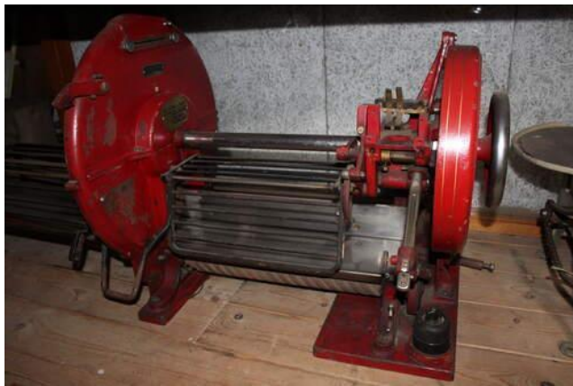
Figuur 3. Links: Deels elektrische kneedmachine van bakker Toon Rooijmans uit Lieshout. (Bron: Fabrikant CAEC, ca. 1910, collectie Boerenbondsmuseum Gemert).
